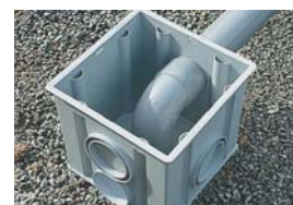
Pour créer un siphon, mettre en place un coude plongeur CT8 ou CX8 éventuellement recoupé.
