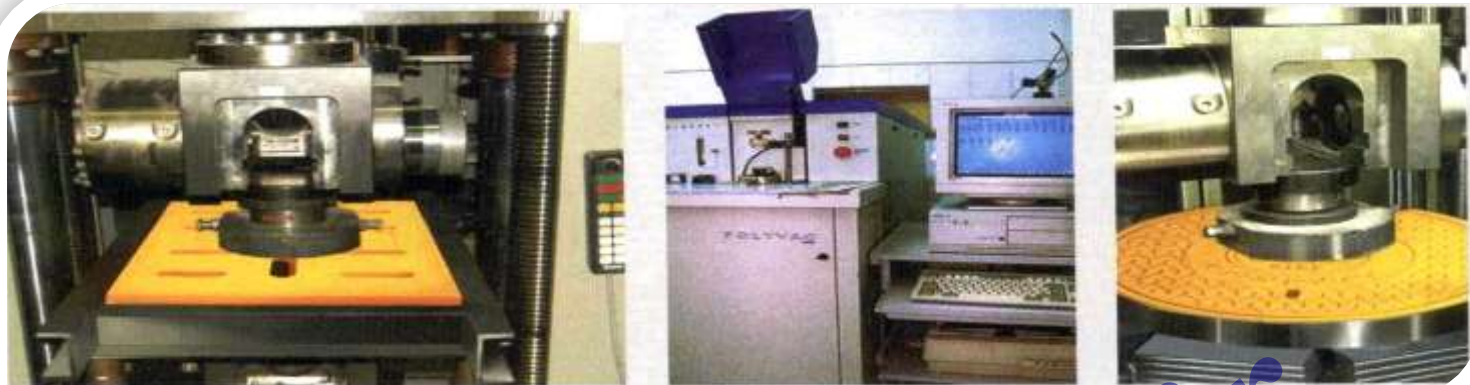
تولید بر اساس استاندارد BS-EN-124 و در کلاسهای وزنی A15 - B125 - C250 - D400
